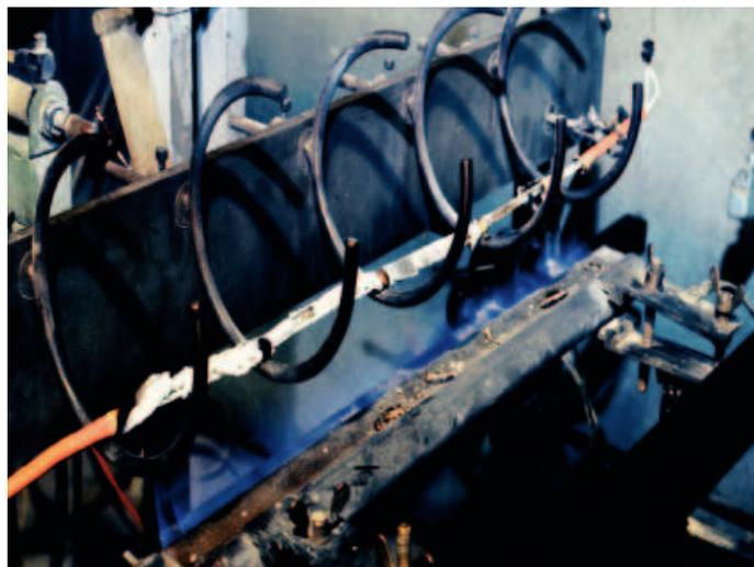
Установка для испытаний на сохранение работоспособности в условиях воздействия пламени.
