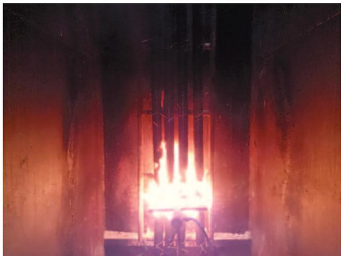
Установка для испытаний на нераспространение горения при групповой прокладке.
