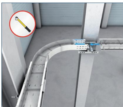
Вставьте следующую секцию лотка с соединительной пластиной (VB) в угол горизонтальный (WPRB) и закрепите в двух местах с каждой стороны.
