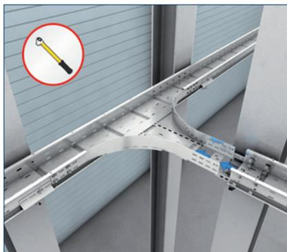
Вставьте примыкающий лоток с соединительной пластиной (VB) в накладной отвод (WPRAA) и закрепите в четырех местах с каждой стороны.
