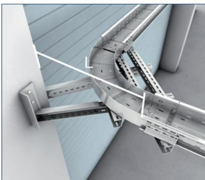
Угловая консоль для тяжелых нагрузок (EBW) для обеспечения горизонтальных поворотов 90 градусов используется с боковым поддерживающим зажимом (WPHS-K) и крепится непосредственно к стене.
