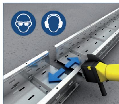
Любые работы с лотком (в том числе резка по металлу) должны выполняться с максимальной предосторожностью и согласно действующим правилам техники безопасности.
