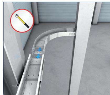
Вставьте угол горизонтальный (WPRB) с соединительной пластиной (VB) в лоток и закрепите в двух местах с каждой стороны.
