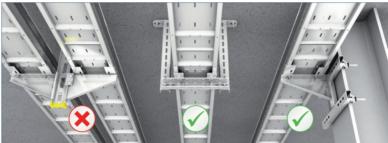
Система несущих конструкций должна полностью исключать скручивание! Одноточечное крепление (например, подвес к потолку) запрещено. Разрешается использование консолей (в том числе настенных) или жестких конструкций.
